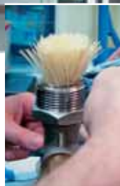
Container-Einbau, Herstellung der Membranmodule aus Polyimid- Hohlfasern, TU Wien / Institut für Verfahrenstechnik
