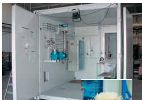
Container-Einbau, Herstellung der Membranmodule aus Polyimid- Hohlfasern, TU Wien / Institut für Verfahrenstechnik
